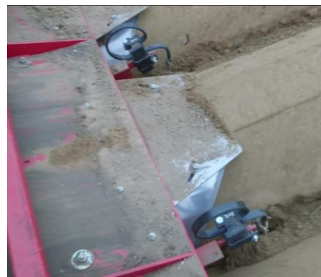
Figure 4 : Dents de vibro fixées sur la butteuse
