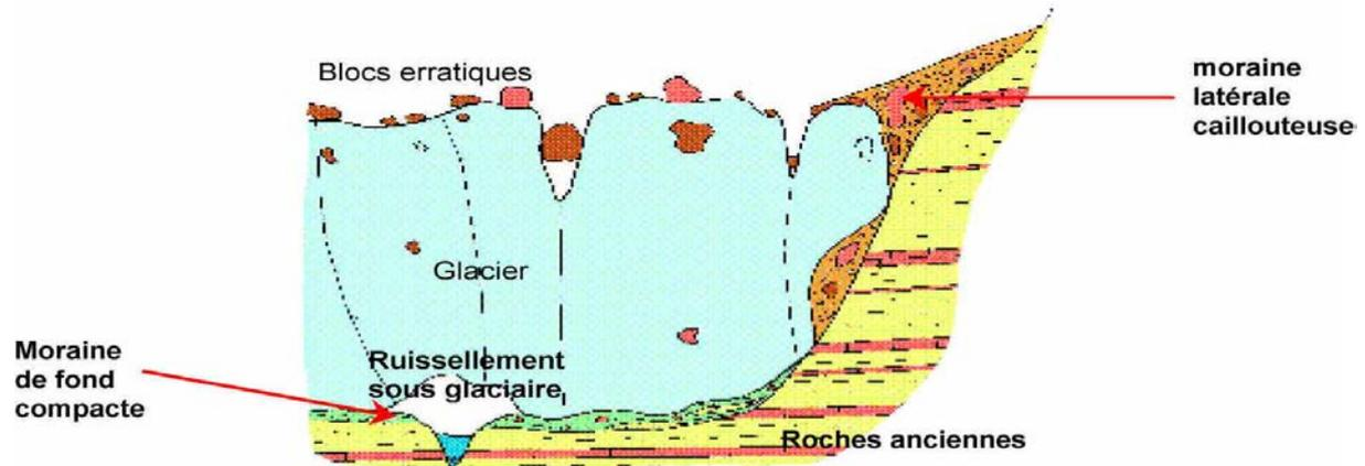
Figure 9 : Coupe schématique d'un glacier
