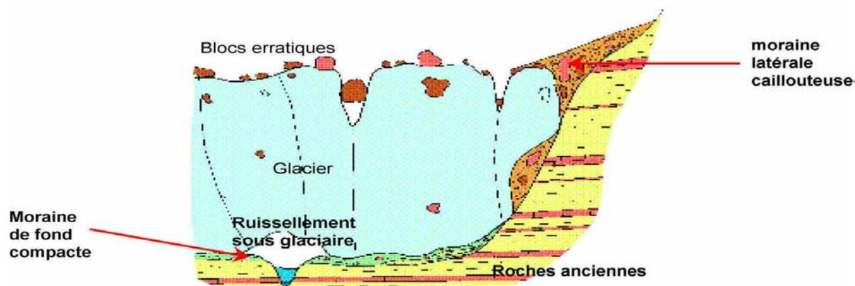
Figure 9 : Coupe schématique d'un glacier
