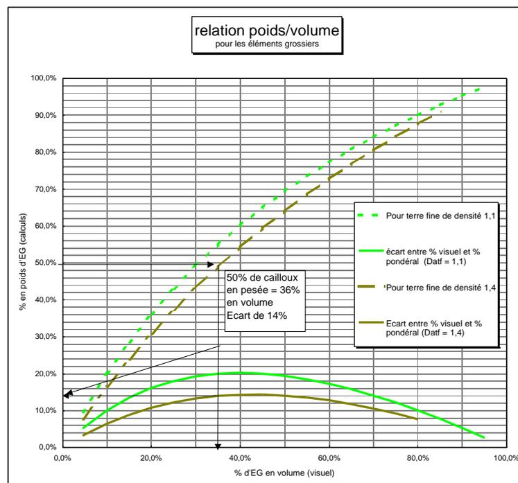
Fig. 3 : Abaque poids-volume pour les éléments grossiers
