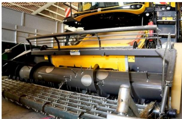
... à même le sol, avant d'être collectées grâce à ce pick-up à tapis installé devant la batteuse. Les graines sont ensuite...
