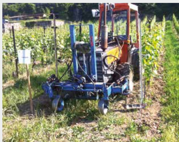
Figure 4 | Travail du sol du cavaillon avec une lame interceps (Source: Proconseil).
