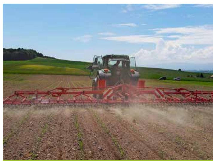
Passage de la houe rotative avant le semis du maïs. PROCONSEIL
