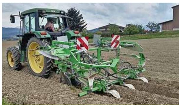
Système AVR avec palettes hydrauliques adapté sur une buteuse.
