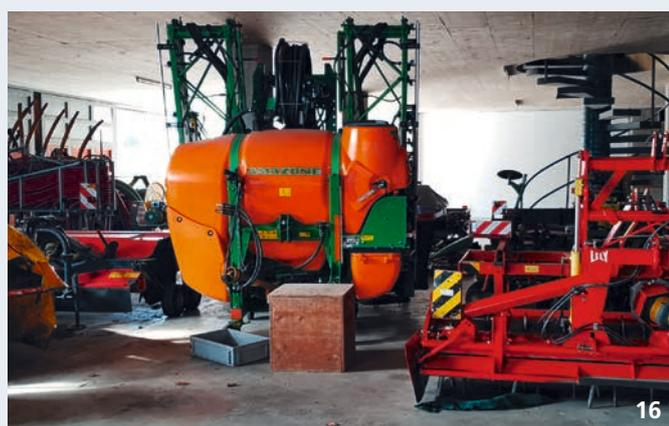
Les pulvérisateurs et les atomiseurs doivent être entreposés sous un toit lors de précipitations. Ceci évite que les résidus de PPH collés aux parois ne soient emportés par l'eau de pluie. Une bâche, recouvrant l'ensemble de l'appareil est également possible. Elle doit pouvoir être installée rapidement et facilement pour que son utilisation soit plausible.
