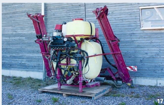
Place inappropriée en cas de précipitations. Le pulvérisateur n'est pas protégé de la pluie. Les résidus de PPH peuvent être lessivés.
