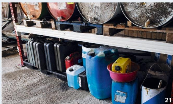
Les contenants font plus de 20 litres et il manque une cuve de rétention avec une capacité d'au moins le plus grand bidon. Il n'y a pas de matériau absorbant pour récupérer les fluides qui fuieraient.
