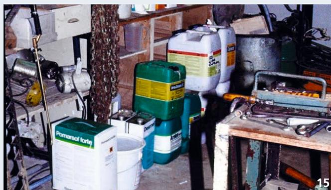
Les produits phytosanitaires ne sont pas stockés dans une armoire ou une pièce séparée qui peut être fermée à clés. Il n'y a pas de matériau absorbant pour retenir les éventuelles fuites de PPH. Les écoulements peuvent atteindre une grille d'évacuation.
