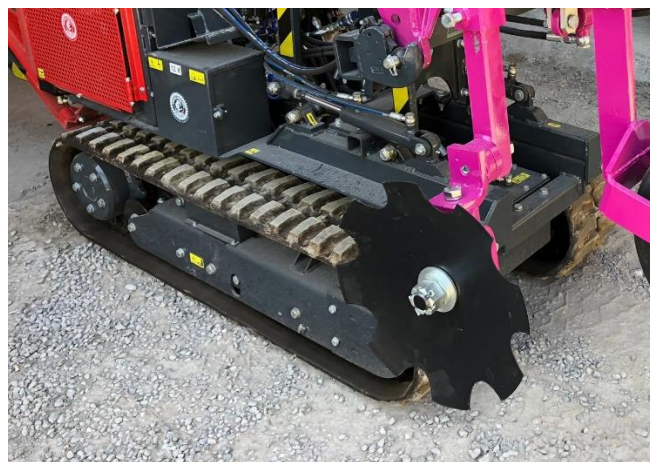
Disques crénelés simples sur chenillette
