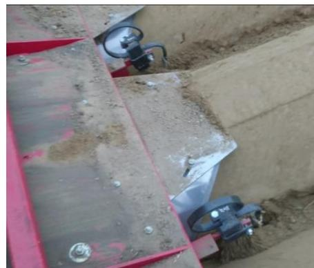
Figure 4 : Dents de vibro fixées sur la butteuse
