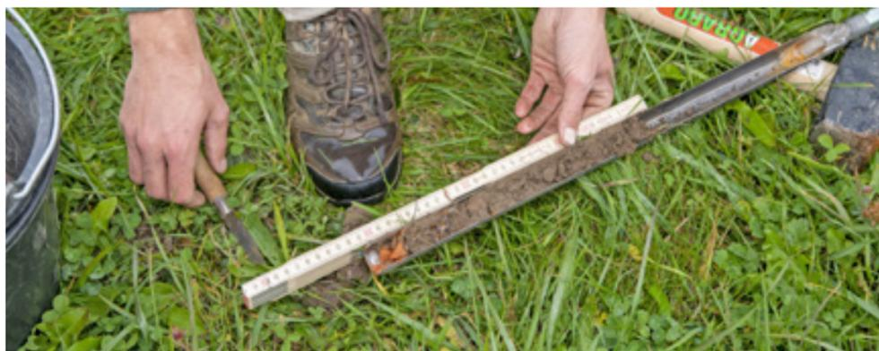
Le carottage doit se faire sur 30 centimètres de profondeur pour que la mesure soit valable.
