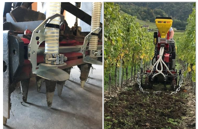
Figure 2: semoirs adaptés sur chenillette (Proconseil, 13/10/22)
