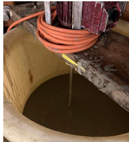
Agitation mécanique avec des bras agitants
