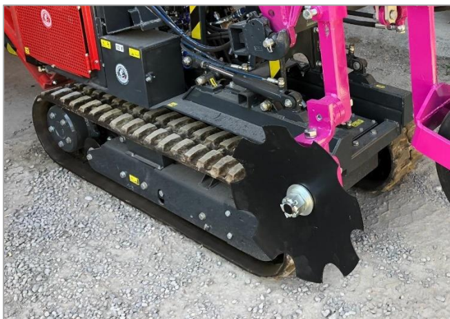
Disques crénelés simples sur chenillette
