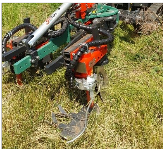
Lame intercep avec effacement
