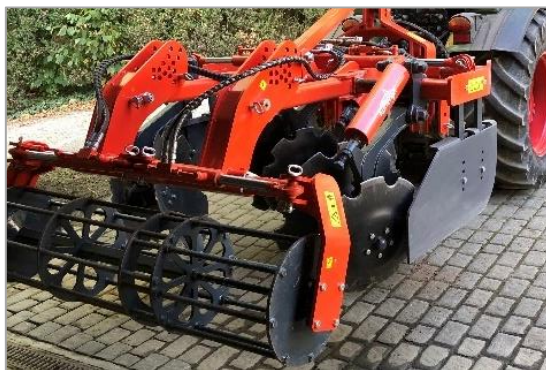
Cover-crop, disques crénelés disposés en V (Denens, C. Ormond). Des systèmes comparables ont aussi été mis au point sur chenillettes.
