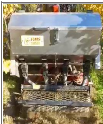
Semoir installé sur une herse rotative (L. Dubouloz et D. Sommer, Ville de Lausanne)
