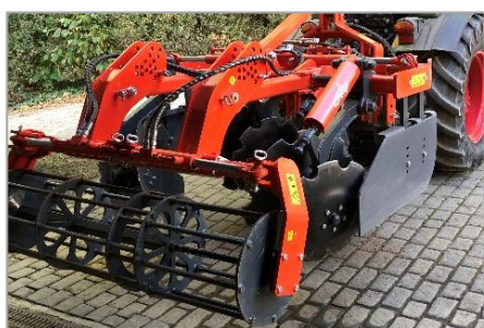
Disques crénelés visant à réaliser un travail superficiel de l'interrang. Source Ch. Ormond.
