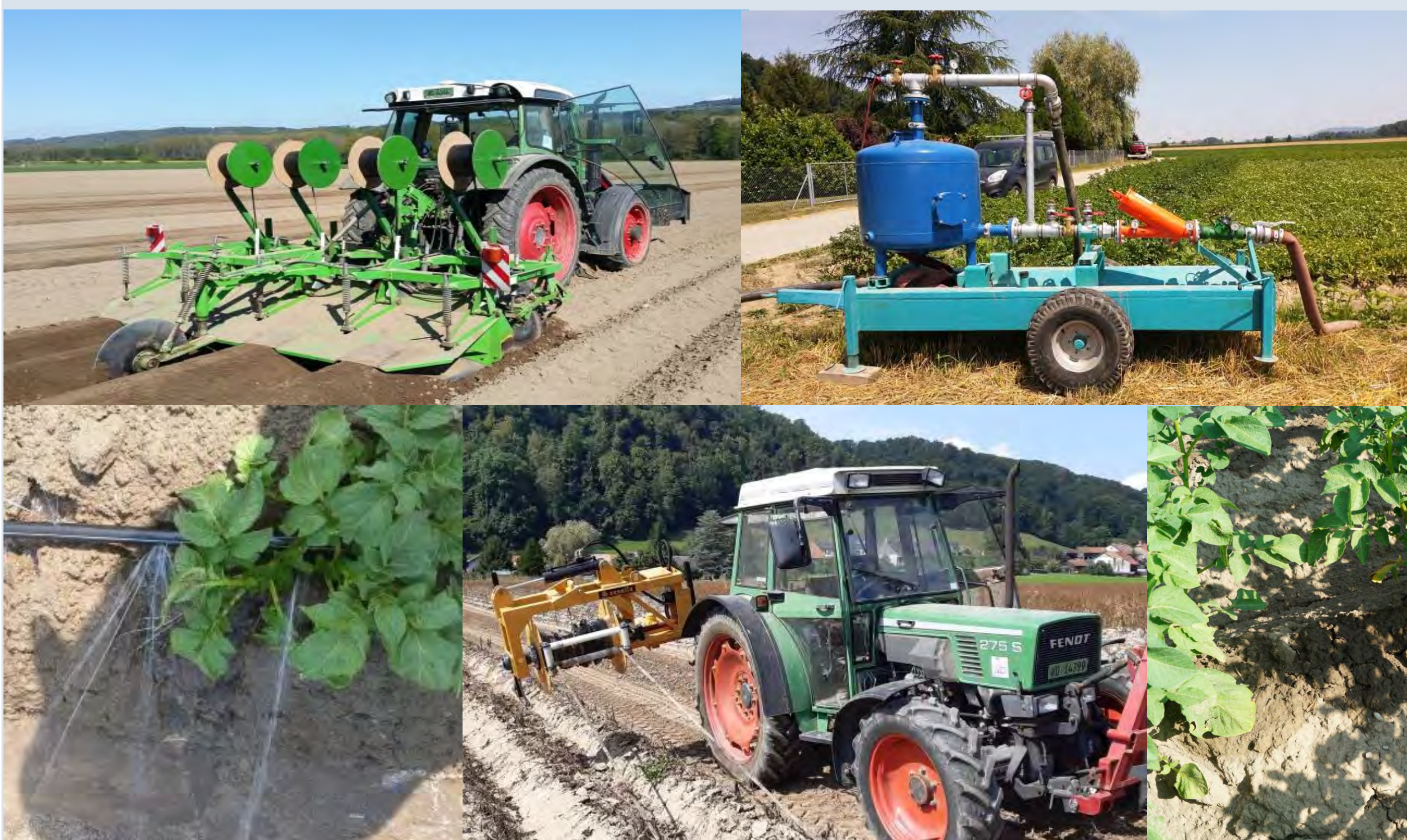
Machines pour la mise en place et la récupération des tubes et station de filtrage. Photos: Joël Terrin.
