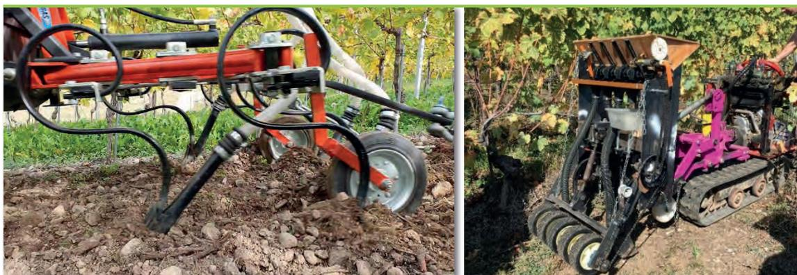
Figure 13 : A gauche, semoir derrière des griffes.
