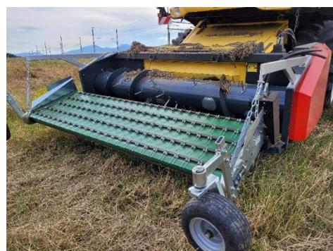
Figure 1: Pick up utilisé pour récolter du colza à Onnens
